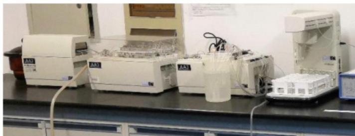
采用连续流动的原理，用均匀的空气泡将样品分开，标准样品和未知样品通过同样的处理和同样的环境，通过对吸光度的比较，得出准确的结果。全自动控制，降低系统误差和人为误差。适合大批量样品快速测定。
