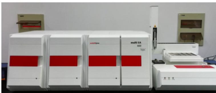
适用于土壤、植物等固体样品中总碳和总氮的测量；固体进样量：最大100mg；测量范围：0.0x ppm—百分含量；精度： $\pm 0.01$ ppm。
