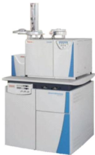
应用范围：用于测定植株、土壤、食品等固体样品中的 $N^{15}$ 、 $C^{13}$ 。外接外围设备多用途气体在线植被装置（GasBench II）及衡量气体预浓缩装置（PerCon）用于测定 $N_2O$ 、 $CO_2$ 、 $N_2$ 中的 $N^{15}$ 、 $C^{13}$ 。
