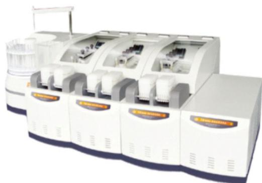
主要用于土壤、植株和水样品的铵态氮、硝态氮、总氮及磷酸盐等物质的测定。高灵敏度检测器，高度重现性，ppb级的检出限。
