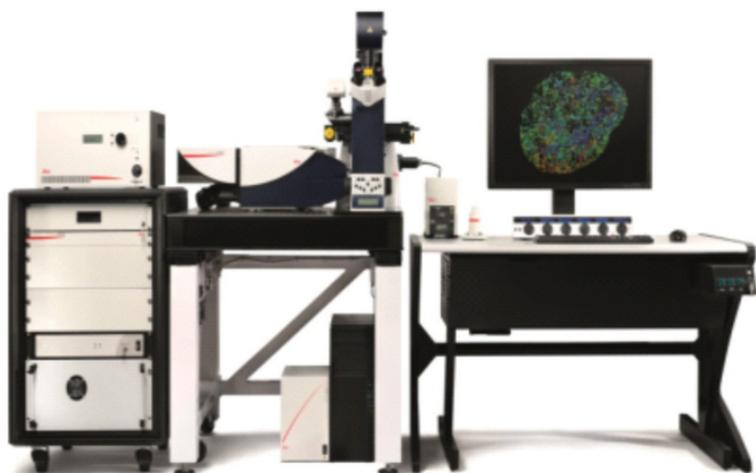
全光谱特征图像: 配有470–670nm连续波长的白激光系统和紫外激光器, 可用于新染料和荧光蛋白发现及其光谱特征的研究。
