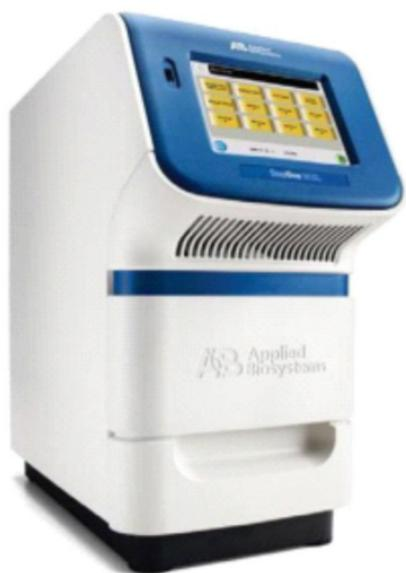
将PCR热循环、荧光检测和 各种应用分析软件结合在一起，对特异性靶基因进行快速检测与定量。
