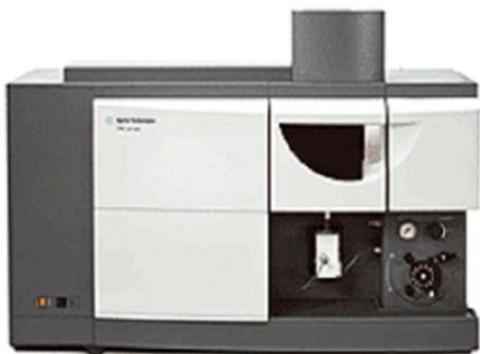
可实现土壤、水、植株等样品中的P、K、Ca、Na、Mg、S、Fe、Al、Si、Mn、Cu、Zn、Ni、Mo、Pb、Cd、Cr、Hg、As、B等73种元素的快速检测，用于生物、土壤学、植物以及环境样品中元素含量的分析。
