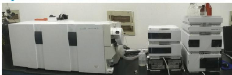
仪器配备**Agilent 1200 series液相色谱**以及**Agilent 6410B 分析质谱**；Agilent 6410B分析质谱配有**ESI软电离**；质谱质量分析器由三个**四级杆**组成。主要用于小分子化合物及其各种体液内代谢产物的测定，农药及化工产品中间体和杂质的鉴定，农残和兽残的分析测定，大分子的蛋白质和肽类的分子量的测定，以及分子生物学等研究中有有机物痕量的定性及定量分析。
