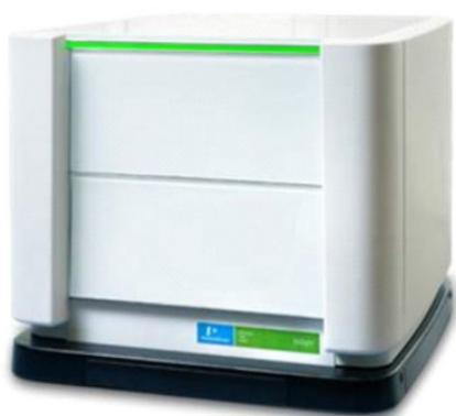
应用范围：可以进行核酸蛋白定量检测、酶动力学检测、激酶检测、受体结合研究、分子相互作用检测、发光底物的免疫分析、报告基因研究、荧光标记免疫实验、核酸与蛋白定量、酶联免疫测定（ELISAs）、细胞因子检测、细胞毒性实验等。
